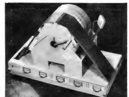
Bild 3c. Geräuschmühle in Stellung „Wind“
