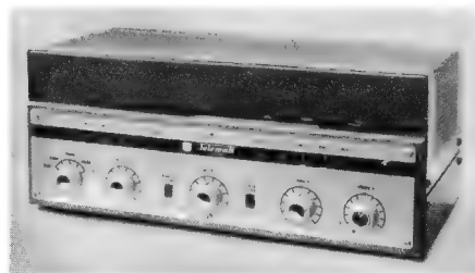
Bild 1. Außenansicht des 40-W-Verstärkers Typ Telewatt-Ultra der Firma Klein & Hummel
