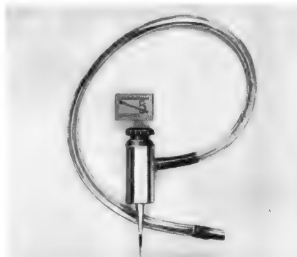
Bild 2. Tastkopf mit Betriebsartenschalter und Abschirmkabel
