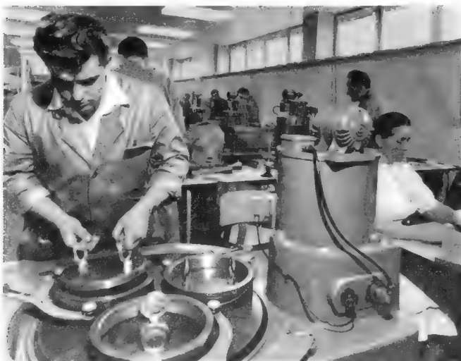
Bild 4. Saal mit Läpp-Maschinen zum Planschleifen von Kristallscheibchen
